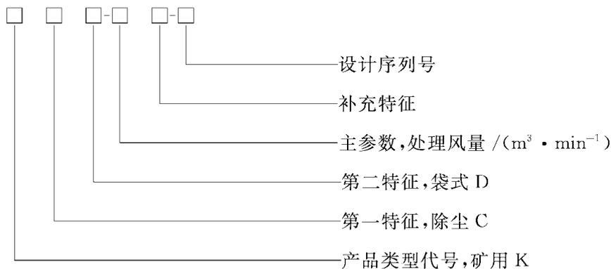
补充特征: 脉冲喷吹 M; 机械振动 Z; 分室反吹 F; 喷嘴反吹 P。
